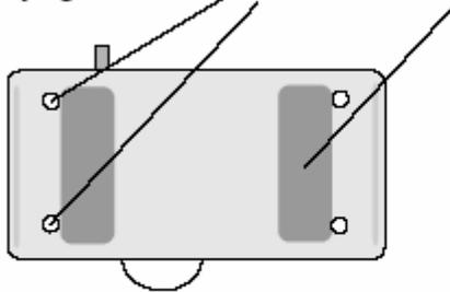
Om det brukes mikrofon, bør den plasseres på høyttalerfronten ved hjelp av borrelåsen (allerede montert på mikrofonen).
