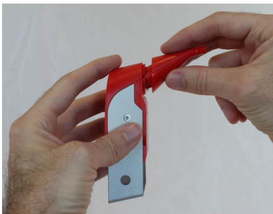
Illustrasjon 9: Avtrekking av munnstykket
