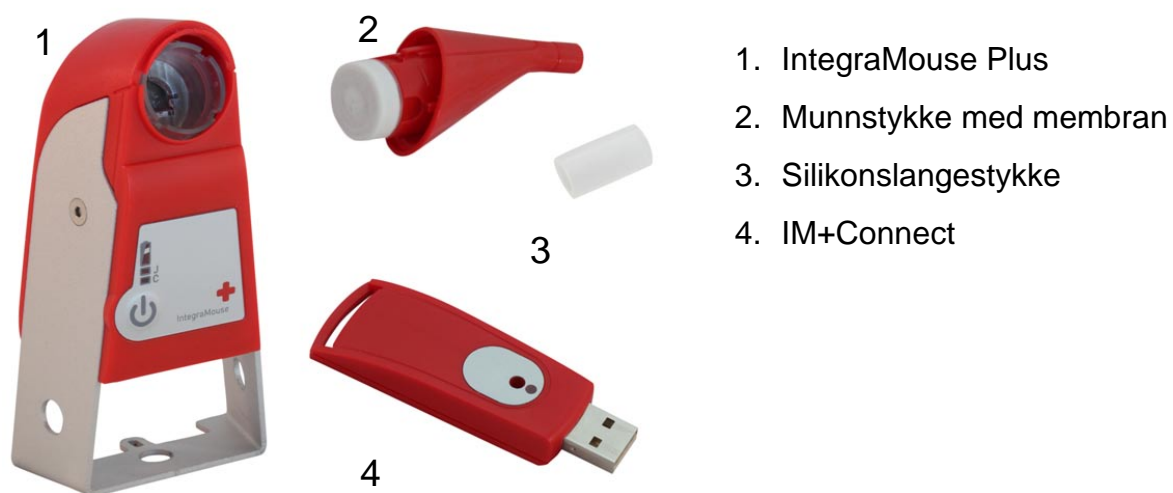
Illustrasjon 2: Komponenter til IntegraMouse Plus
