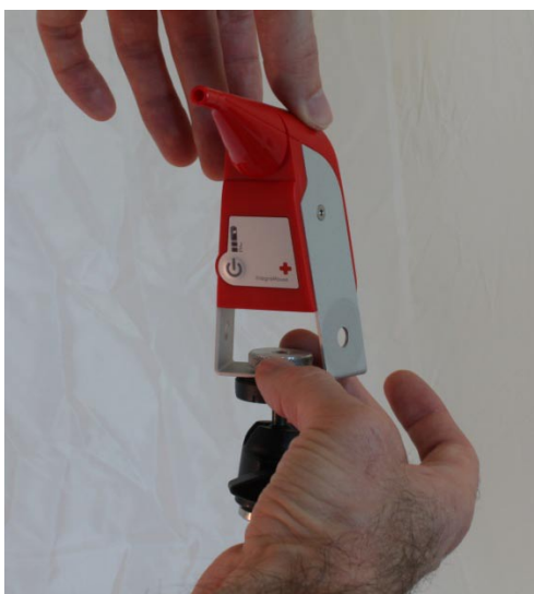
Illustrasjon6: Montering av IntegraMouse Plus
